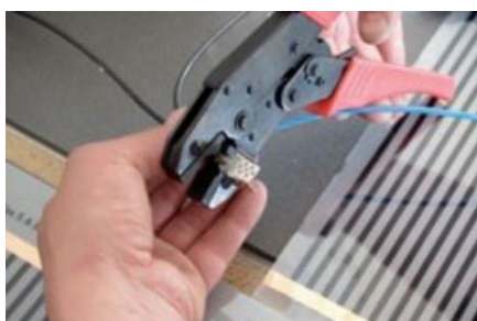
Zalisovanie vodičov ku krimpovaciemu konektoru
